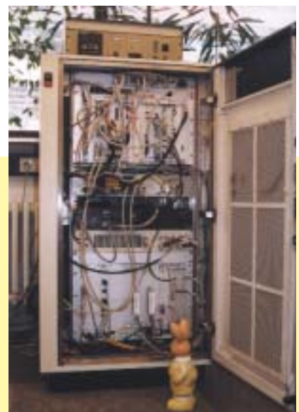
Steuerungssystem der Eierfärbemaschine (Kathrin König)
